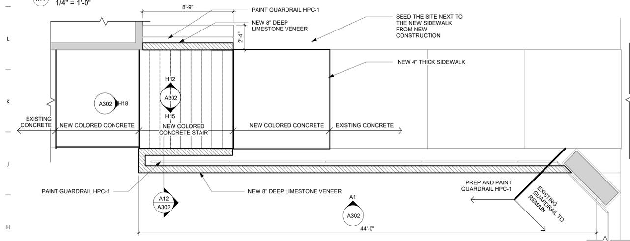
**H1 PLAN - RETAINING WALL NEW WORK**
