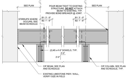
5 TYPICAL CIP BEAM DETAIL
