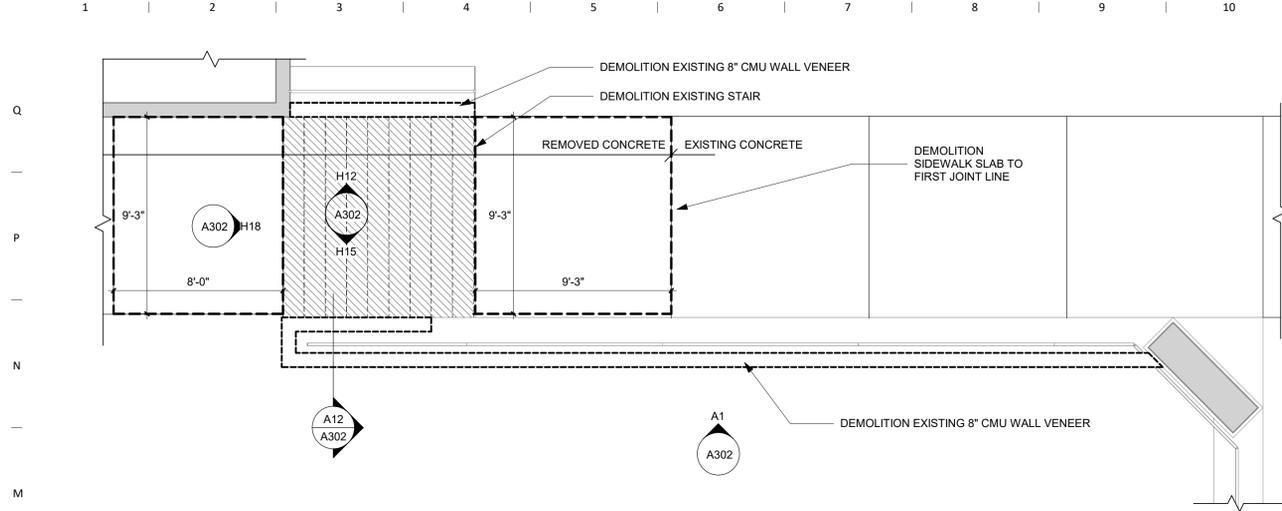
**M1 DEMOLITION PLAN - RETAINING WALL**
