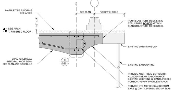
7 TYPICAL SLAB EDGE DETAIL @ CIP BEAM
