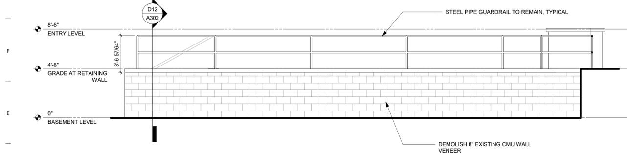
**D1 DEMOLITION RETAINING WALL ELEVATION**
